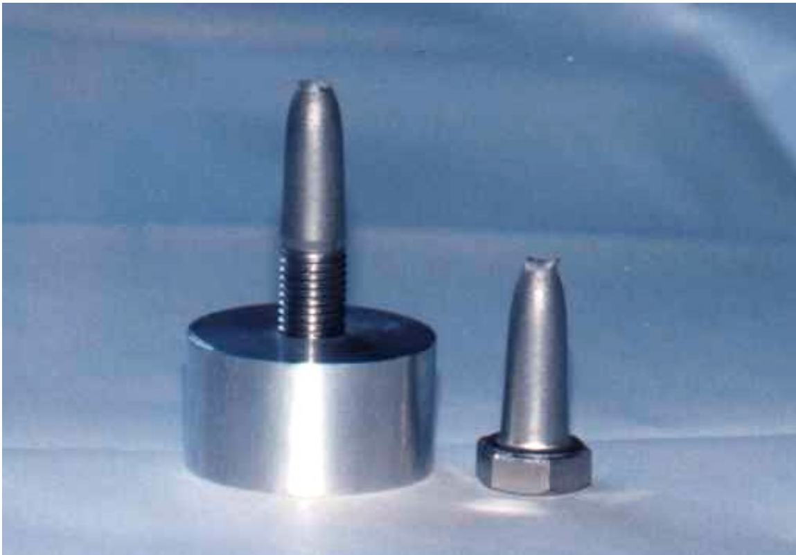
Bild 4: Austenitischer Bolzen A2-70, M 16 mit Alumutter aus 3.0615.71 (F 28) Einschraubtiefe: m = 21 mm, Längung: 25 mm, Bruchkraft: F = 128 kN
